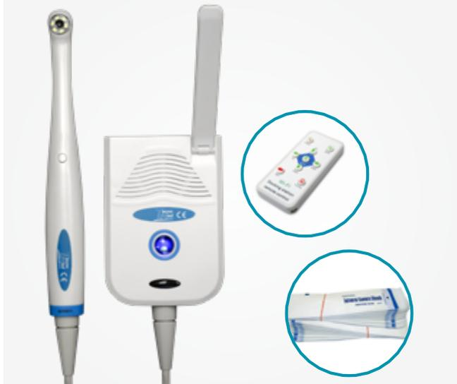
Funziona anche senza computer. OUTPUT 1 collegamento a monitor con VGA (o HDMI con adapter). OUTPUT 2 collegamento a PC in WIFI. Sensore CCD 1/4" Sony alta sensibilità. Con autofocus. Risoluzione 2.0 Mpixel. Illuminazione 6 led. Peso manipolo solo 45 gr. 50 protezioni monouso INCLUSE.
